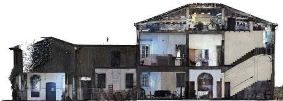
**Figura 3.1.** Nuvola di punti ottenuta da un rilievo eseguito con metodologia laser scanner 3D, sezionata in modo da ottenere la sezione di un edificio caratterizzato da adiacenze e superfetazioni. Risulta così più agevole definire correttamente le interazioni tra i vari corpi di fabbrica a livello degli orizzontamenti e individuare eventuali zone non ispezionabili da sottoporre ad indagini più approfondite.
