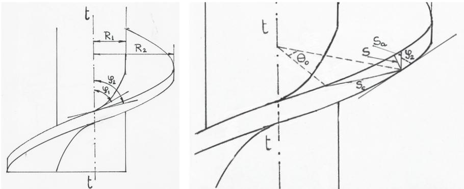
Figure 7. I parametri del verme elicoidale.
