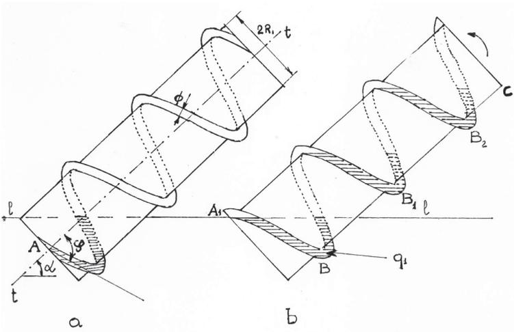
Figura 1. La vite di Archimede.
