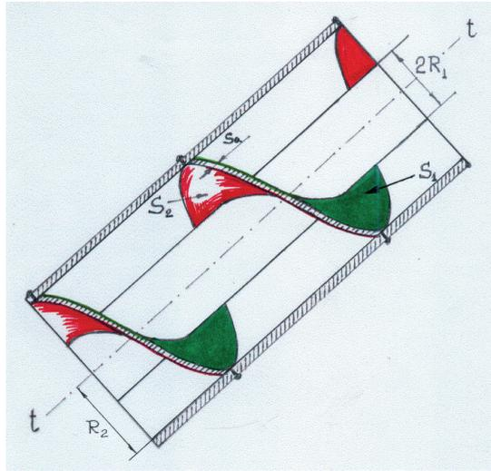
Figura 6. Vite di Archimede ad un solo principio.
