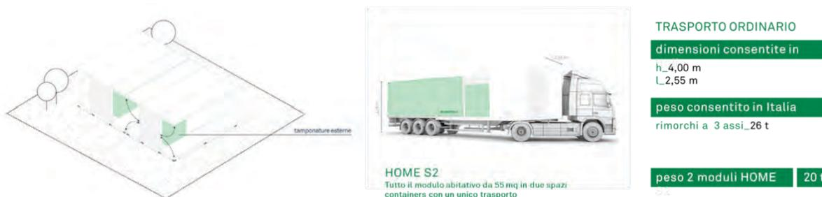
Figura 3. Trasporto ordinario su rimorchio a tre assi e schema di apertura dei moduli. (design: A. Procopio, 2017)
