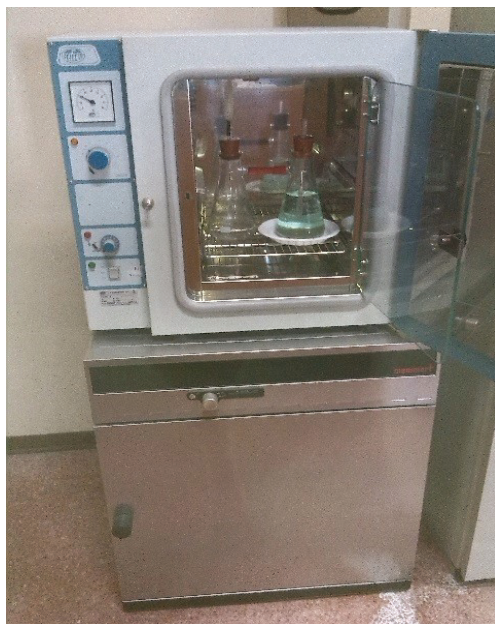
Foto 4 - Camera di crescita utilizzata come ambiente isolato termicamente dove far avvenire le misure di solubilità.
