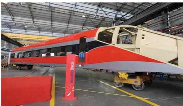
Fig. 3 – Fase di costruzione di un treno AV/AC.
